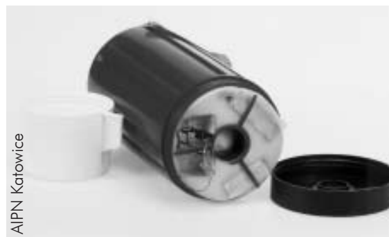
Podsłuch zamontowany w termosie
