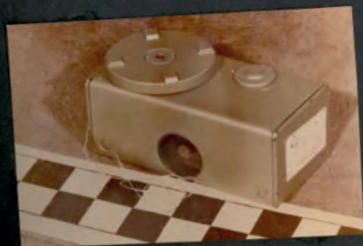
Sposób ukrycia miniaturowego aparatu fotograficznego i światłomierza. Jeden film wystarczył do wykonania około 100 zdjęć.
